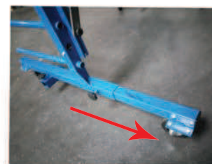
Base du châssis étirable pour plus de stabilité
