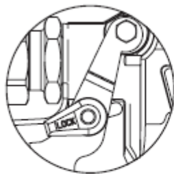
Détente bloquée (le pistolet ne pulvérise pas)
